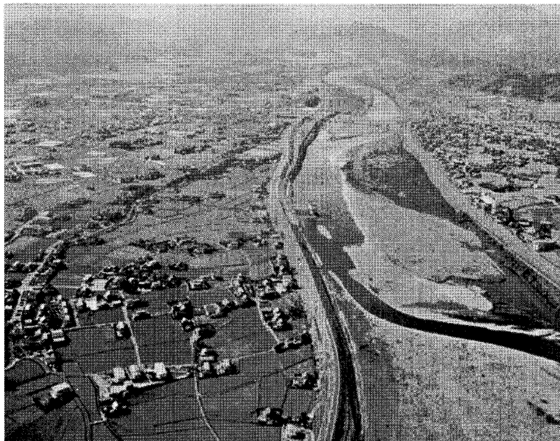
図 I-3 那賀川（徳島県）の交互砂州 （国土交通省徳島工事事務所提供）
