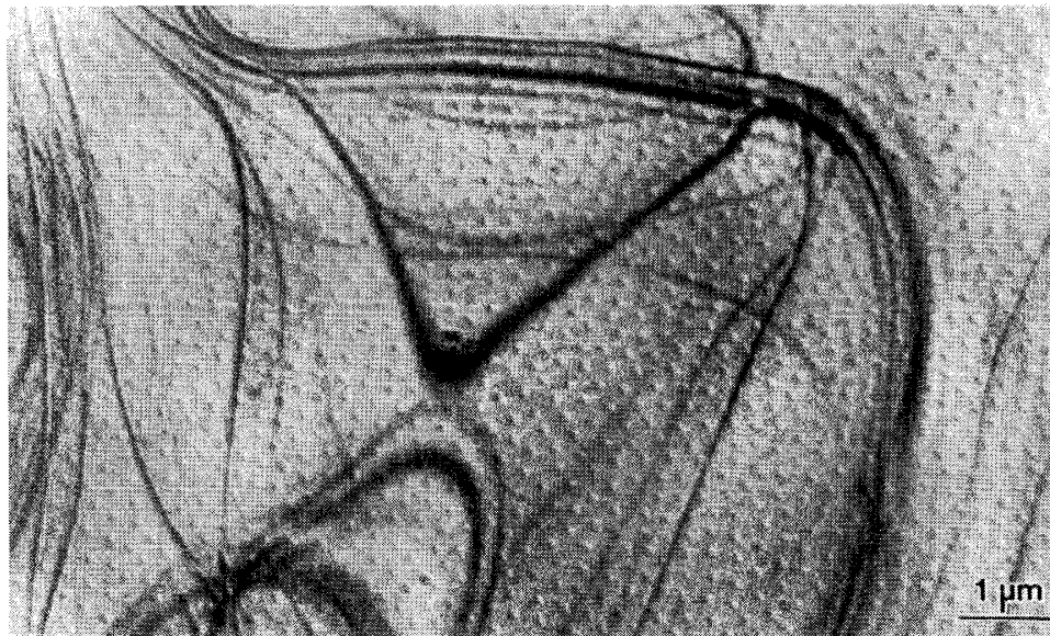
図3 ニオブ薄膜中の磁束量子のローレンツ顕微鏡像
