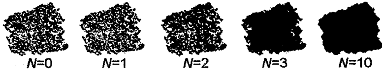
図3 宇宙塵 2 値化像の dilation/erosion 操作 (3 次元) による変化。
