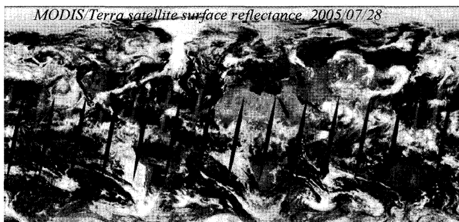
図 19 人工衛星 Terra の MODIS センサから得られた水平解像度 5\text{km} \times 5\text{km} の地表反射率の画像(白い部分は全て雲)。我々は遠からず、このように微細な雲分布をシミュレートできるようになるだろう。しかし、そのときシミュレーションはどのような意味をもつだろうか？
