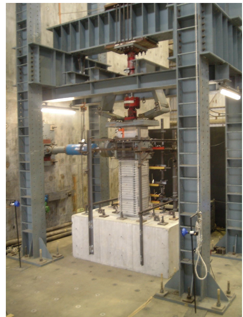
写真-3.2.4 荷重装置
