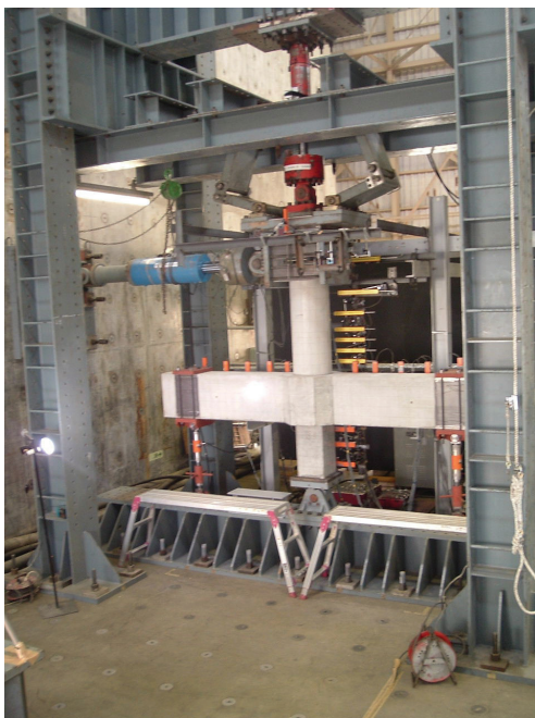
写真-5.5.1 載荷装置
