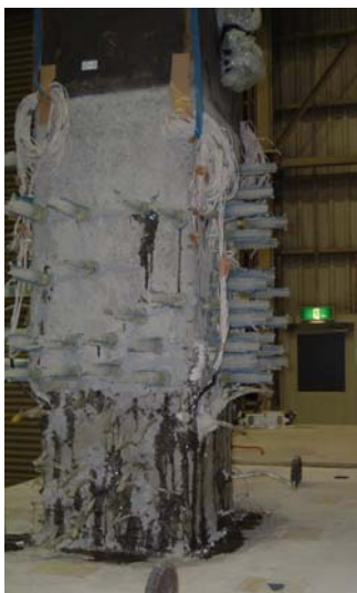
(c) エポキシ樹脂注入
