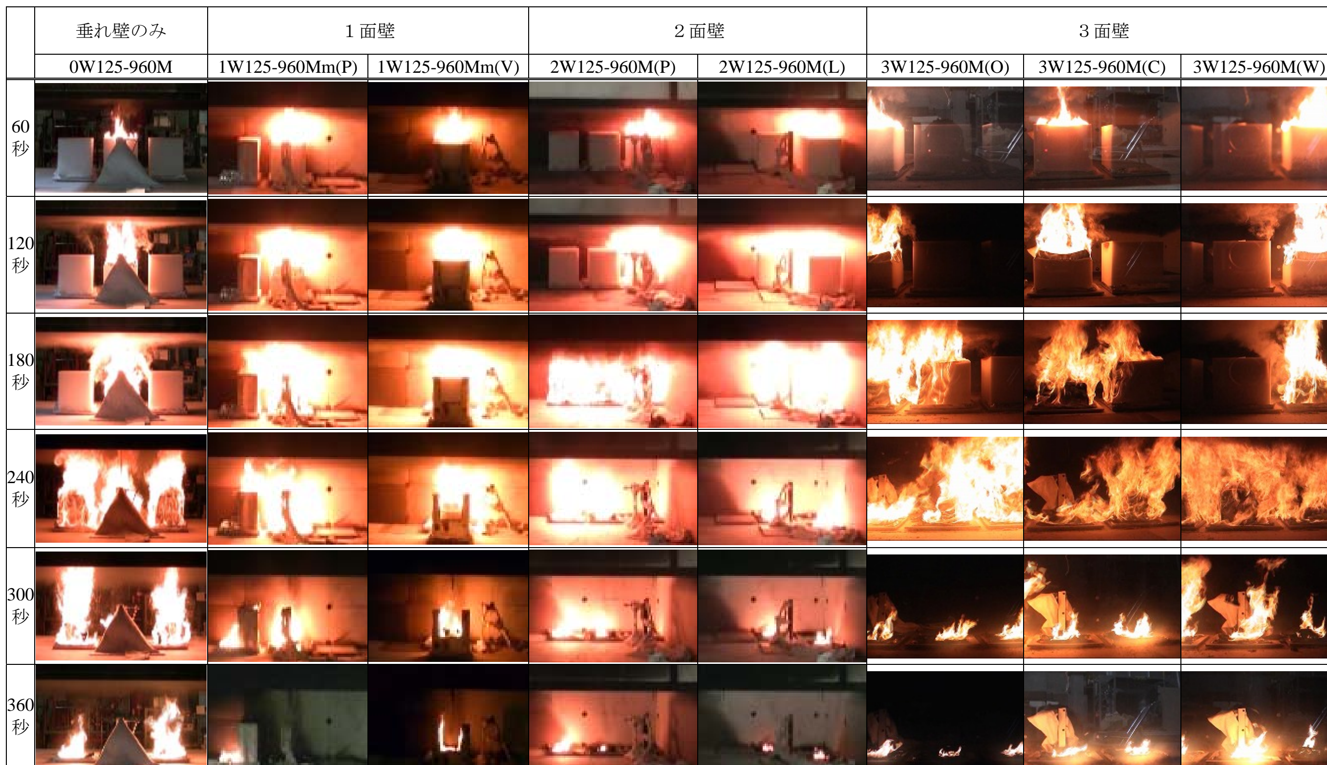
図 5-8 実験 B~D の延焼拡大の様子
