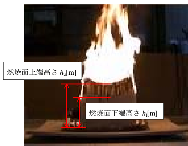
図 4-1 3 鉛直面が燃え下がっている状況
