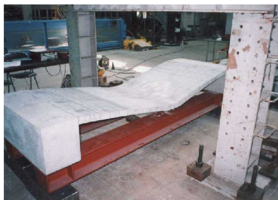
写真-3.6 載荷完了後の模型
