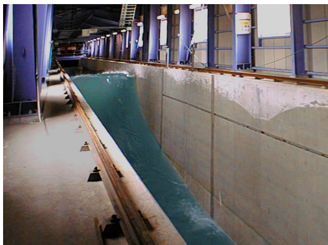
写真-3.3 実験水路
