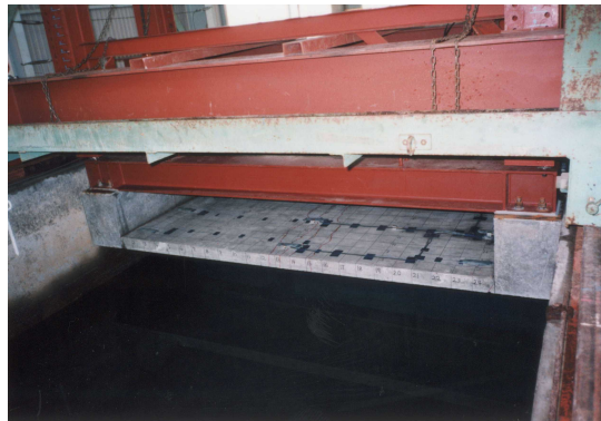
写真-3.7 破壊実験の RC 版模型
