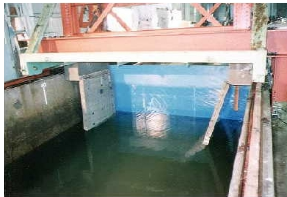
写真-3.8(5) RC 版の破断(H)
