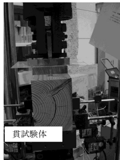
図 2. 21 (a)Case B(貫上部・楔アサメラ) (b)貫部材の割れ目部分
