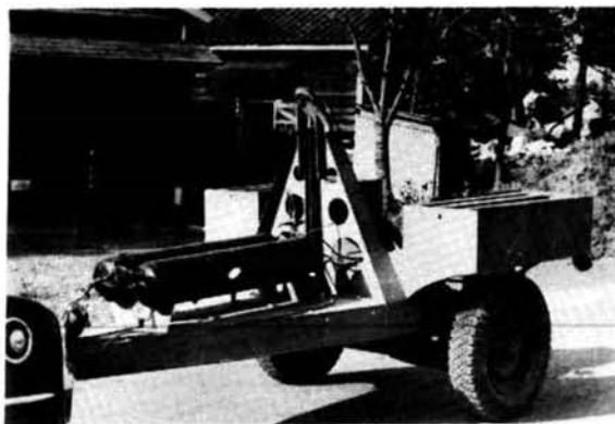
図 5-15 すべり測定用トレーラー（土木研究所）
