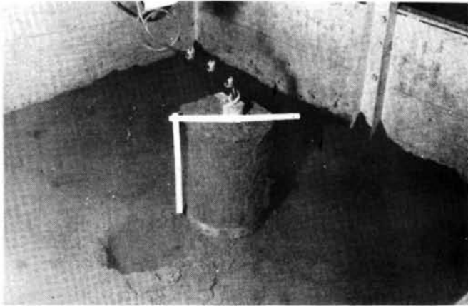
写真 1.5.5 引揚げられた土塊 (鉛直掘り施工の場合)
