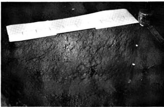
写真1.5.3 観察されたすべり面の一例 (断面CO)
