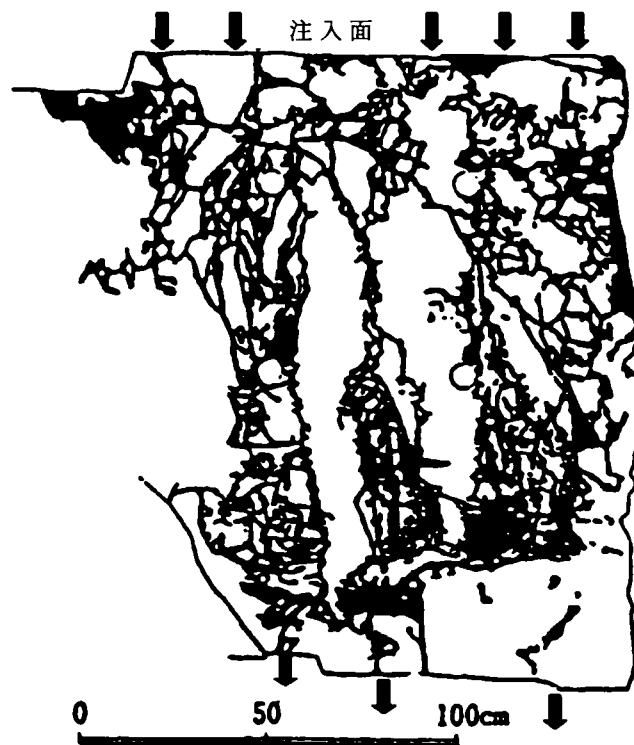
図-2. 7 不連続面中の水みち測定結果 1)
