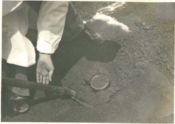
その4. 乾燥密度測定のためのエアカッターによるサンプリング
