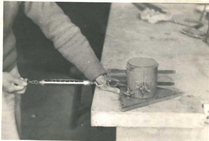
写真一Ⅱ、1 ストリップ引抜き試験
