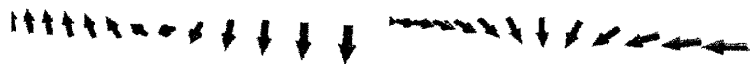
図 4: 2つの典型的磁壁構造。磁化容易軸が磁化の変化方向と直交して、磁壁中の磁化の回転面が磁化変化方向と垂直な場合を Bloch wall (左図)、磁化容易軸が磁化の変化方向と一致している場合を Neel wall とよぶ (右図)。2つはスピン空間と空間座標の相対的な角度の違いであるので、スピン軌道相互作用などスピンと軌道を結合させるような相互作用がなければ両者の伝導特性や電流に対する応答に差はない。
