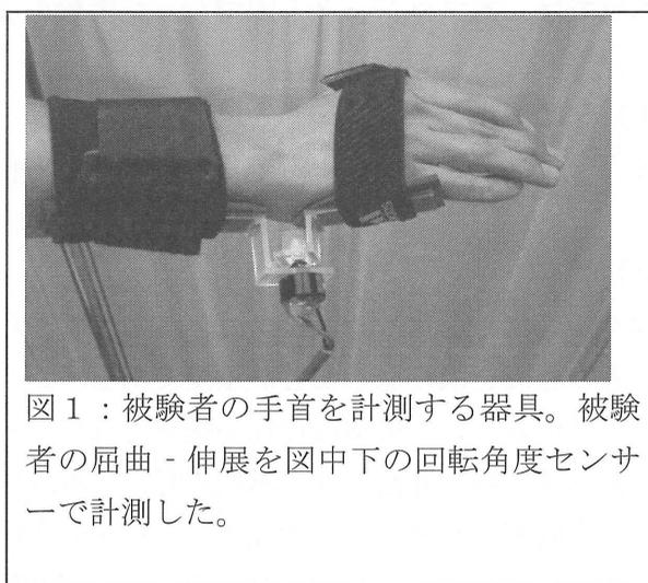
図1: 被験者の手首を計測する器具。被験者の屈曲-伸展を図中下の回転角度センサーで計測した。
