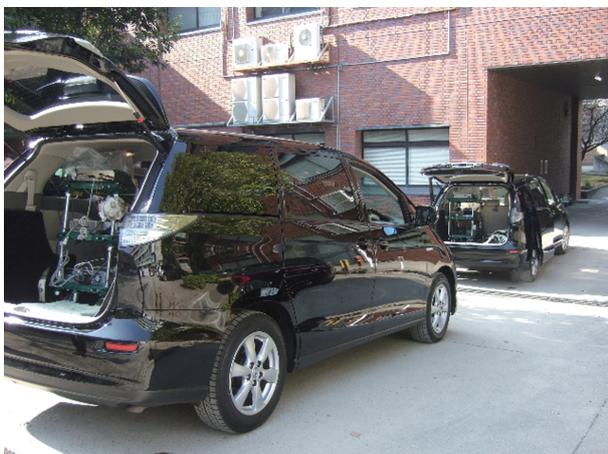
図 1. 無線装置を積み込んだ発呼車両と宛先車両。この他構内に中継局を 2 局設置した。
