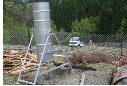
ヒノキの間伐材の皮をむき、焼き杭をつくる。
