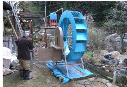
でき上がった水車発電システム。まずは、ホースで水をかけて稼働実験。
