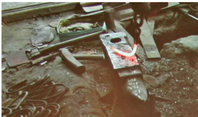
写真 2 片井鉄工所でのカン制作。熱した鉄の棒を槌でたたいて U 字に曲げていく
