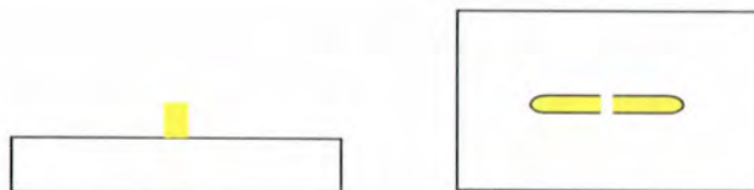
図 6.22 ポジ型レジストを用いた場合の多層レジストプロセス
