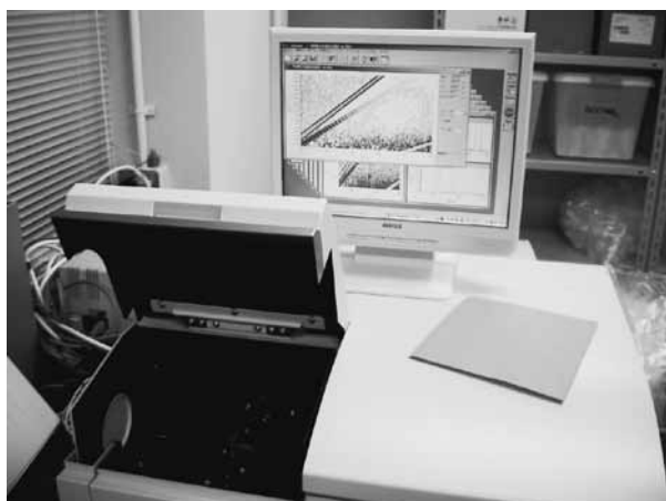
三次元分光蛍光光度計 左手前は、試料室のフタを開けたところ
