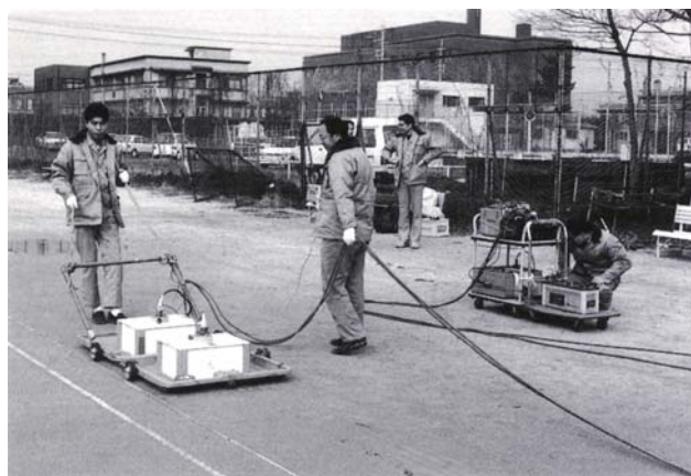
図1 地中レーダーによる探査
