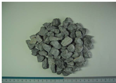
図-4.3 実験に使用した砕石（5号砕石；13～20mm）
