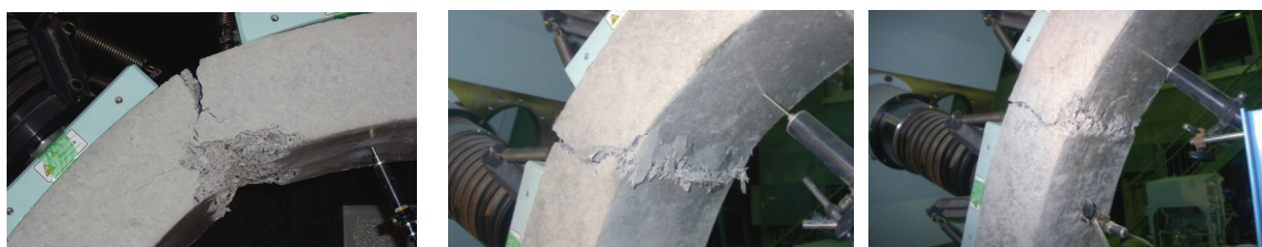
(a) 無筋コンクリート (b) ポリプロピレン繊維補強 (c) 鋼繊維補強
