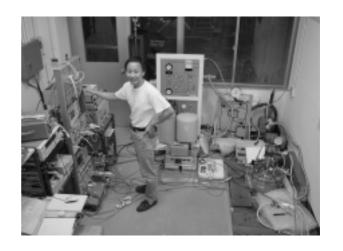
(4) 宇治キャンパス・極低温物性化学実験室 1 階(実験室) 当センター宇治キャンパスでは,平成 14 年度に化学研究所より移管された平成 3 年度購入の SQUID 磁束計(Quantum Design MPMS-5)を,共同利用装置として管理・運営しています.装置仕様は,磁気モーメント感度 1×10<sup>-6</sup> ~ 3×10<sup>2</sup> emu,最大印加磁場 5 T,測定可能温度範囲 2 ~ 400 K(専用炉使用時は ~ 800 K)で,磁気抵抗効果測定オプションが付いています.利用者には液体ヘリウム代(1 日あたり 10 L として半日単位で計算)を負担していただいております.利用御希望の方は,低温物質科学研究センター・宇治キャンパス・壬生(内線:宇治 3108)または化学研究所・極低温物性化学実験室・楠田(内線:宇治 4357)まで御連絡願います.
