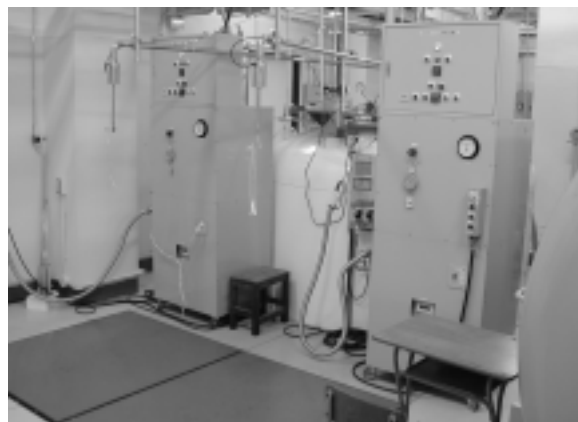
図2 6000 L 液体ヘリウム容器と汲み出し装置
