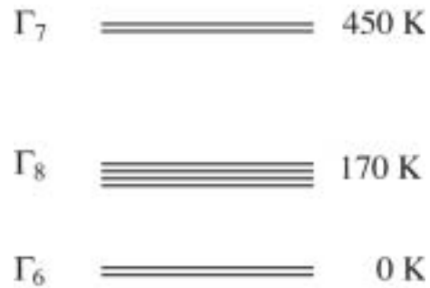
図 2 結晶場分裂した Yb 3+ のエネルギー準位．
