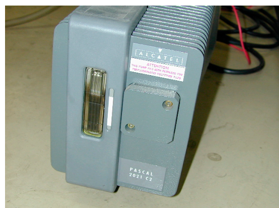
(f) ガスバラスト弁を閉止した例
