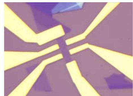
図1 2層グラフェン試料電極部。
