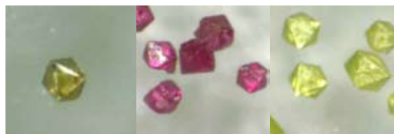
図 4. フラックス法で作成したパイロクロア弗化物の結晶 (左から Cd_2Fe_2F_6S , Cd_2Co_2F_6S , Cd_2Ni_2F_6S )
