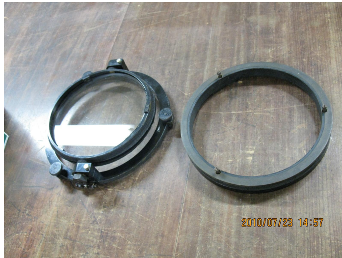
図1 対物プリズムの取り枠と取り外されたプリズム (筆者撮影)
