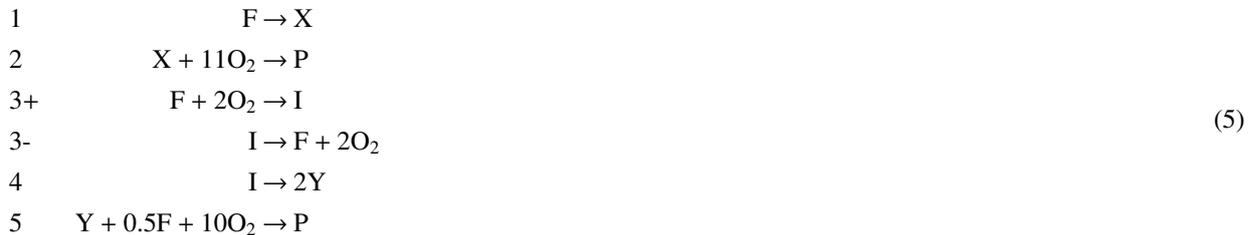
ここで、F は燃料、X は燃料の熱分解生成物、Y と I は低温酸化反応における中間生成物であり、P は  $\text{CO}_2$  と  $\text{H}_2\text{O}$  からなる最終生成物である。本研究で対象とする条件で Schreiber らの反応速度定数を用いた場合、詳細反応計算に比べて着火遅れを短く見積もるため、詳細反応計算と比較し調整をした速度定数を用いた。詳細は付録にて述べる。
