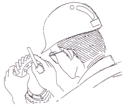
図2-2. ハンドラッピングによる打こんの手修正法
