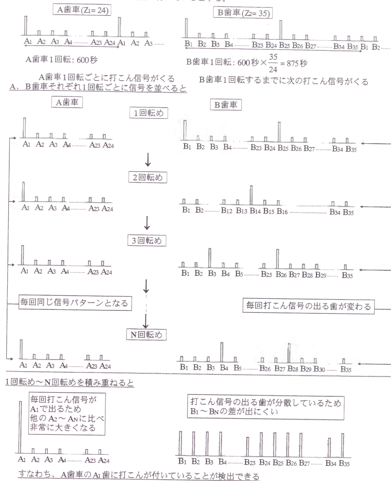
図 2-10. 振動エネルギーによる打こん検知原理
