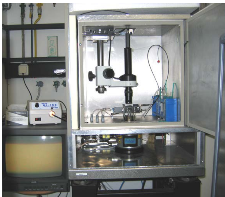
図 A.3 液中環境下計測用の FM-AFM 装置外観.
