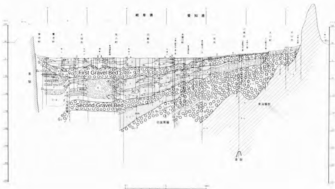
図 1-8. 沈降量の読み取りに使用した地下地質データ（建設省ほか，1962；桑原，1985） 建設省ほか（1962）の柱状図からは，±1 m の精度で深度を読み取る事が可能．桑原（1985）の柱状図では，深度の目盛りを十分割し（一目盛り 5 m），深度を読み取った．
