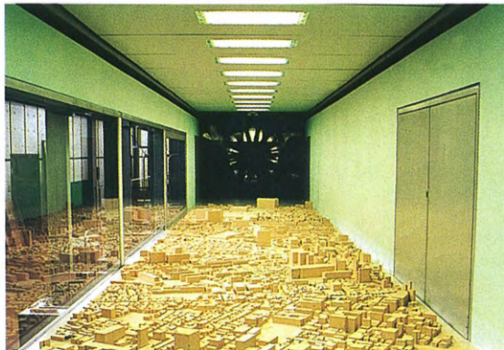
▲写真2. 境界層風洞による実験
