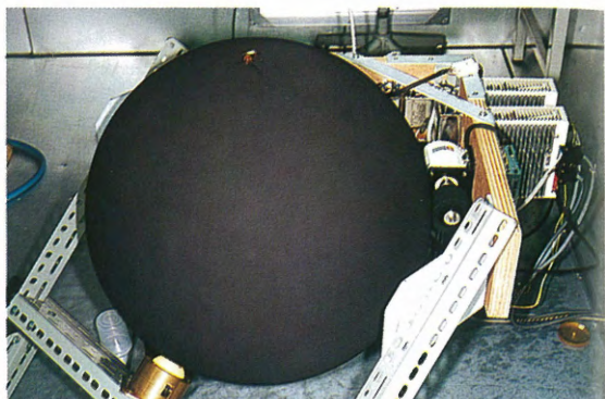
▲写真4. 移動運動補償装置上のワモンゴキブリ：匂い空間での探索プログラムの解析に使用
