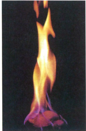
▲写真3. 海底エネルギー資源 「メタンハイドレート」 (燃えるスノーボール)
