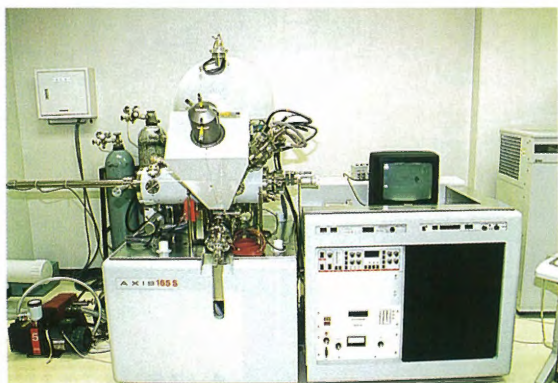
ベンチャー・ビジネス・▶ ラボラトリー （ナノ構造表面評価装置）
