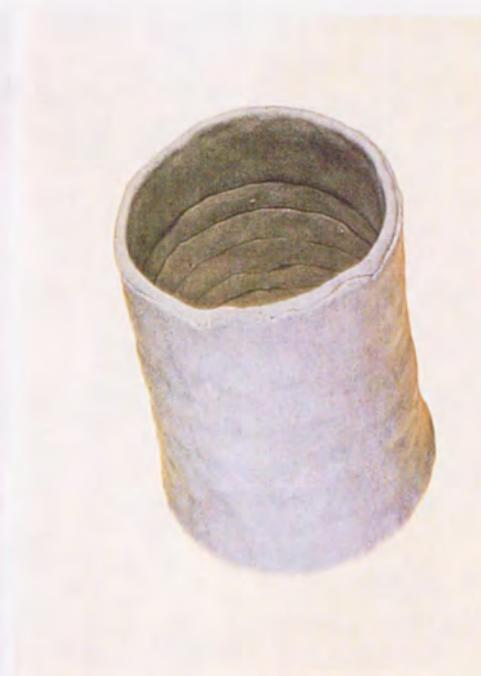
2 粘土紐巻き上げ成形 焼成温度1230℃
