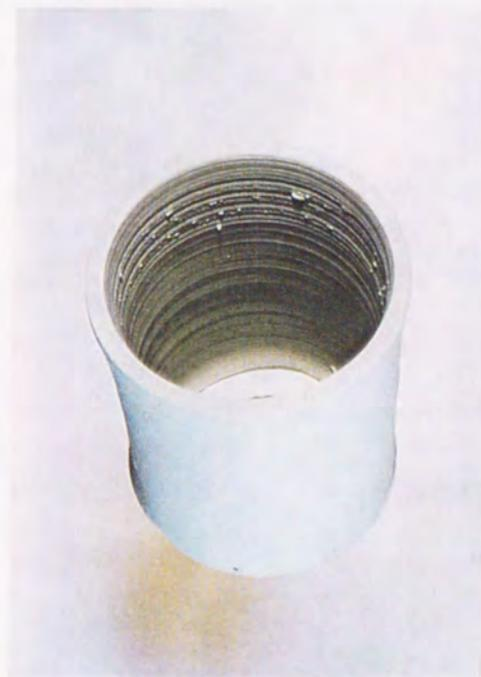
3 ロクロ水挽き成形 焼成温度750℃
