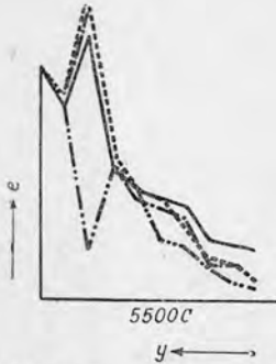
第136圖 中性點に誘導抵抗を有する場合の電位分布 實線：中性點開放時 點線：L=9ヘンリー 鎖線：L=1.56ヘンリー 假想線：L=0.26ヘンリー
