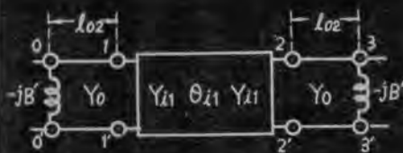
オ3.15図 映像パラメータによる等価回路
