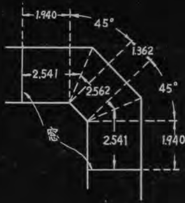
※3.21図 2項定理の係数に従うコーナーの寸法 ( f_1 = 4000 MC)
