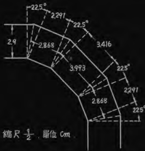
オ4.6図 f_1=3700\text{MC} , f_2=4200\text{MC} を完全伝送する4回屈折コーナーの寸法
