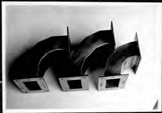
※4.10図 試作した超広帯域4回屈折コーナー 右より (1) 2項定理の係数に従うもの。 (2) f_1, f_2 なる2個の周波数を伝送 するもの。 (一番左は 等間隔 等屈折角の4回屈折にて 比較に供す。)
