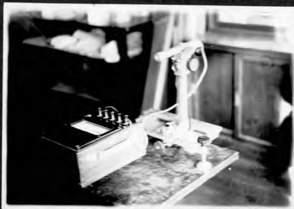
9.10 表面波線路用定在波測定器 負荷時の Q=800 の同軸波長計を 1/100 mm まで読める移動装置に設置し検波電流を 10\mu A の精密級電流計に接続する。
