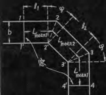
※3.2図 誘導性窓によつて2個の周波数を完全伝送するコーナー
