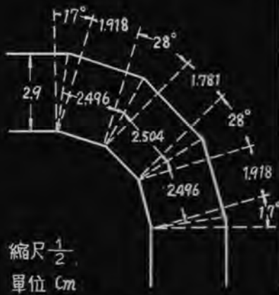
※4.8図 2項定理の係数に従う4回 屈折Eコーナーの寸法 ( f_1=4000 MC)
