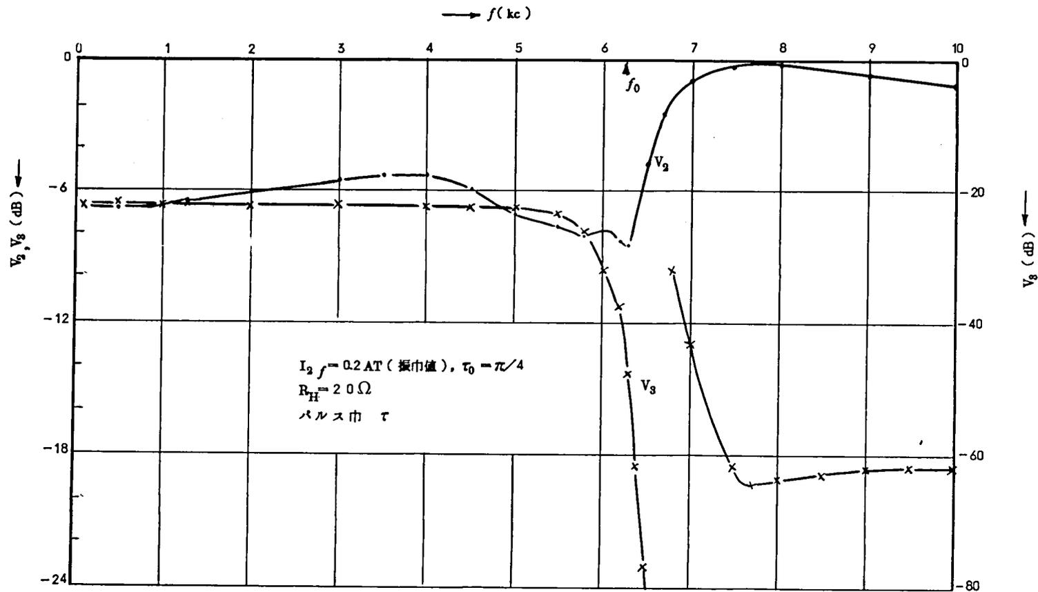
図 3.10 (c)  $V_2, V_3$  のレベル特性 (VII. パラメータ励振で  $R_H$  の効果を相殺した場合)
