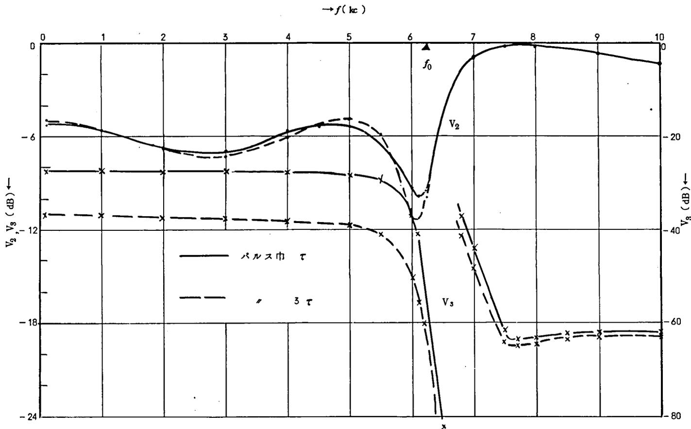
☒ 3.8  $V_2, V_3$  のレベル特性 (Ⅳ.  $I_2 f = 0.2 \text{ AT}$ ,  $\tau_0 = 3\pi/4$  の場合)
