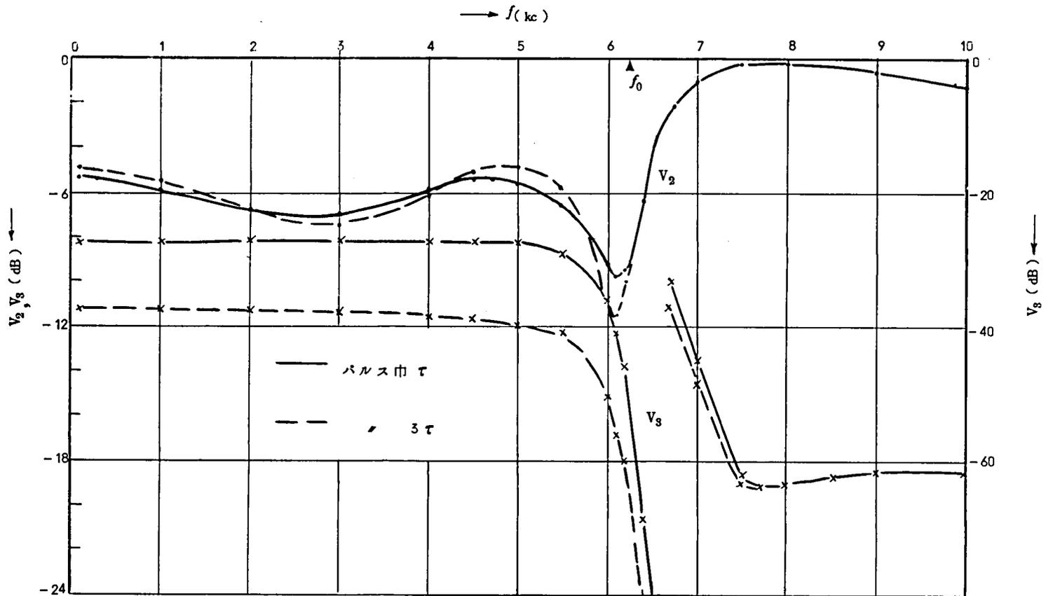
図 3.10 (b)  $V_2, V_3$  のレベル特性 (VI.  $R_H=40\Omega$  を挿入した場合)
