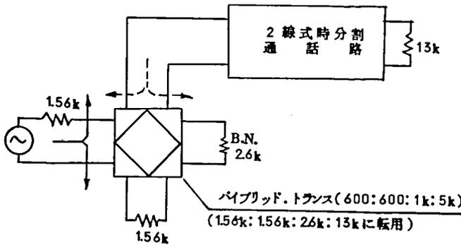
図 3.18 側音減衰量測定回路
