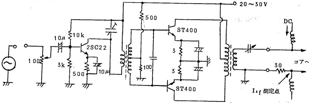
図 A. 6 高周波励振電源回路図
