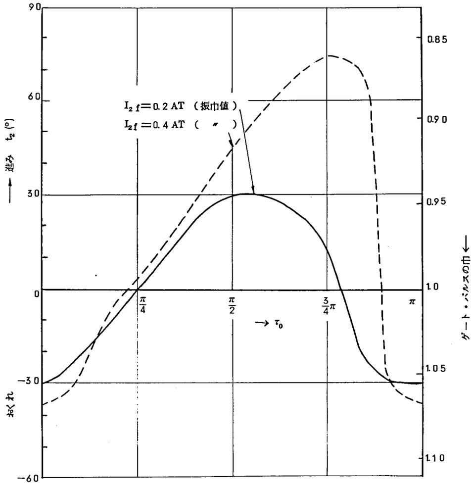
図 2.36  $i = 0$  になる時刻の  $3\pi$  ( $540^\circ$ ) からのずれ
