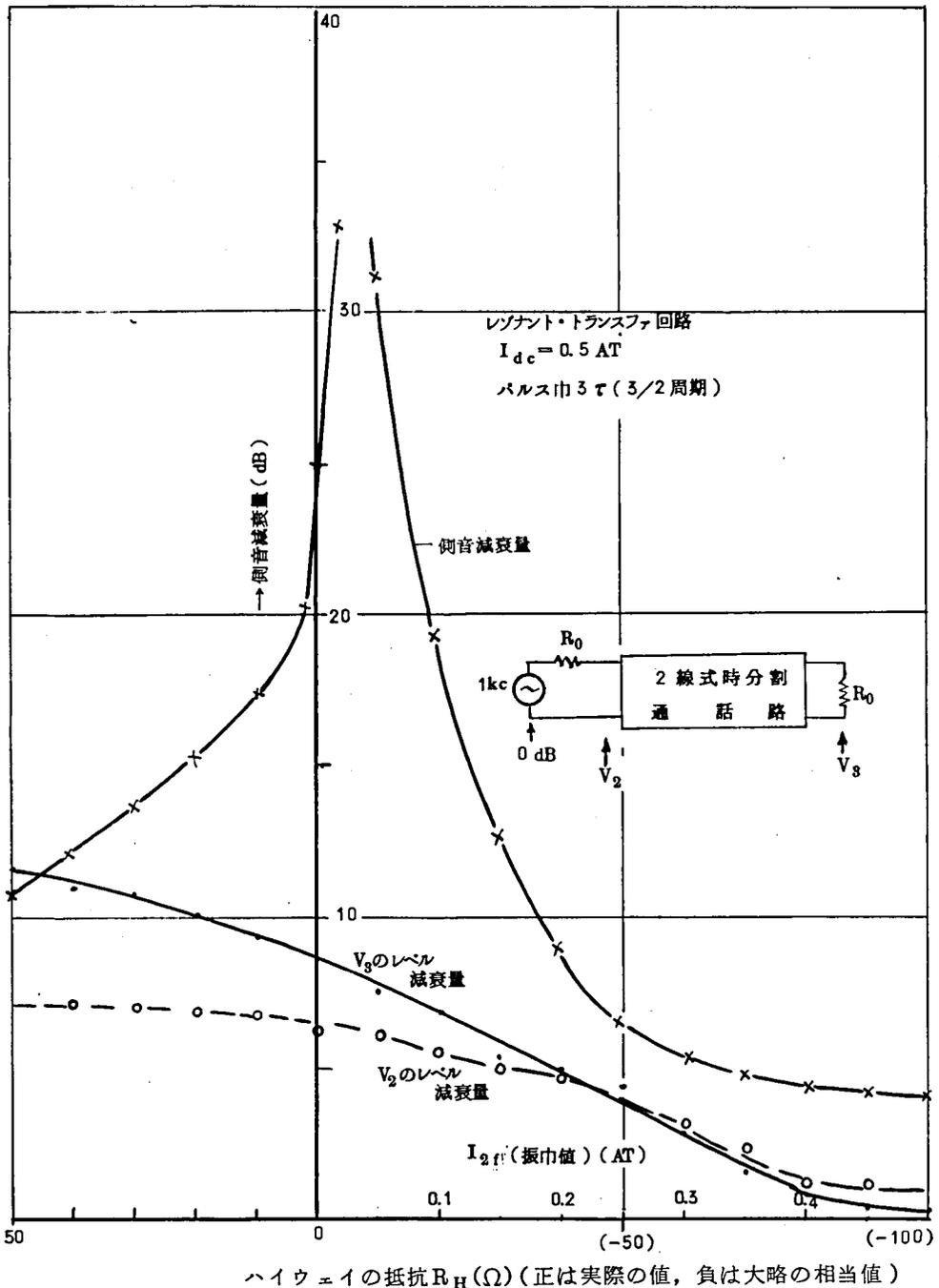
図 3.19 利得(損失)に伴う側音の変化 (I)
