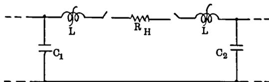
図 3.9 故意に損失を生ぜしめる方法
