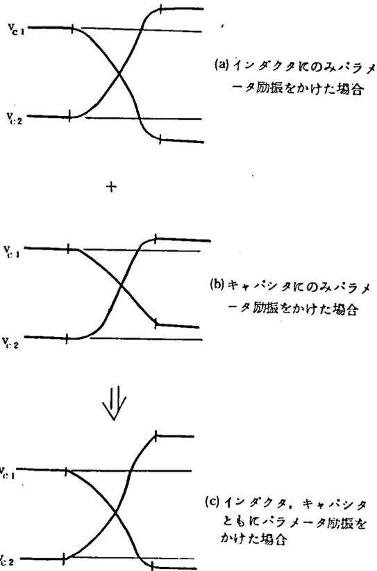
図 4.2 3 インダクタ、キャパシタのパラメータ励振の効果の定性的説明図
