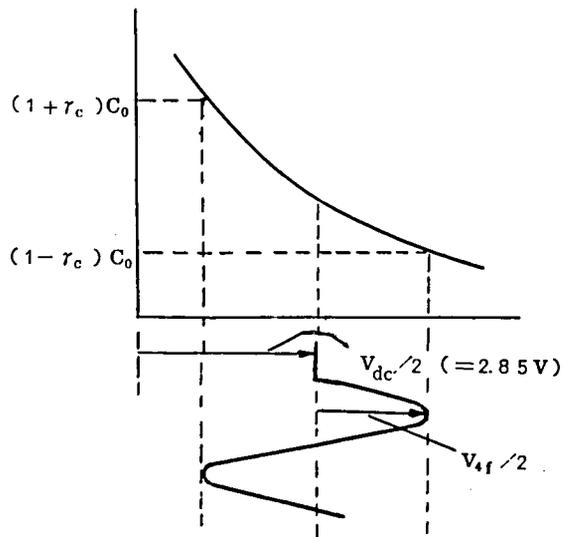
図 4.12 図 4.9 をもとにした  $r_c$  の概算法
