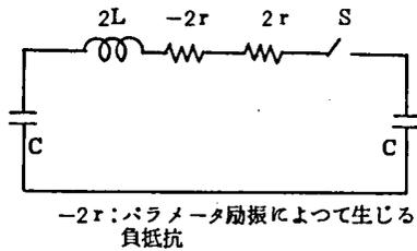
図 2.17 負抵抗による損失補償の原理図
