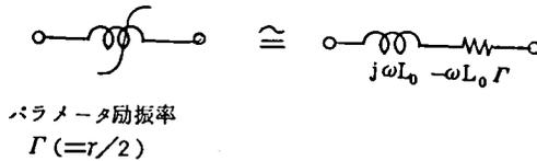
図 2.16 パラメータ励振をかけられたインダクタの定常状態等価回路
