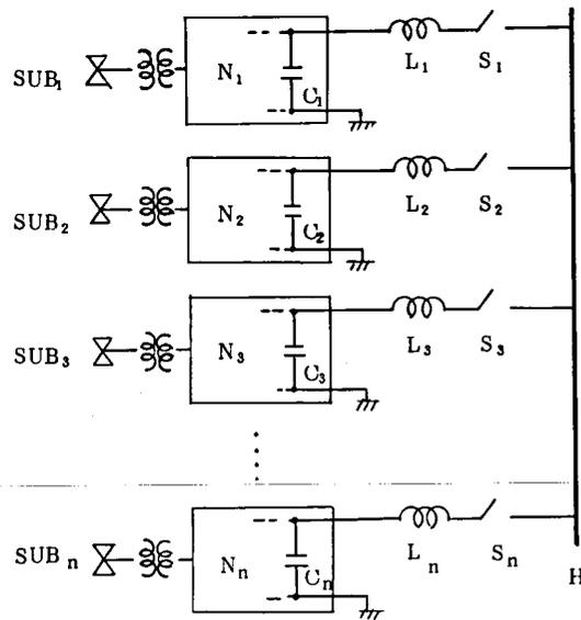
図 1.7 2線式時分割交換機の通話路構成例
