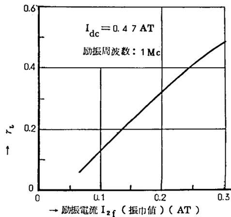
図 4.1.4 可変インダクタの $r_e$ 特性
