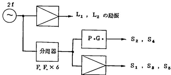
図 2.2 0 実験回路のブロック図
