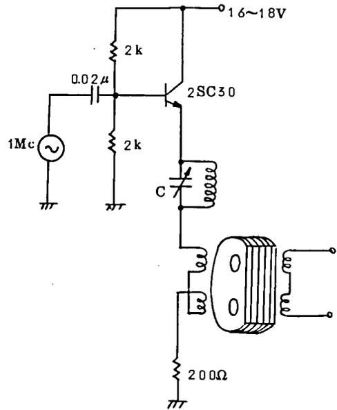
図 4.1.3 インダクタの励振回路
