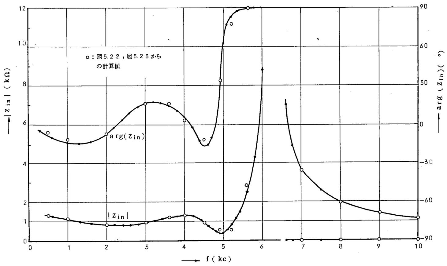
図5.21  $Z_L=1\text{ k}\Omega$  (公称インピーダンス)を接続したときの入力インピーダンス $Z_{in}$ の周波数特性
