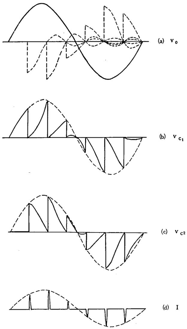
図 1.5 電流インパルスとキャパシタ  $C_1, C_2$  の端子電圧
