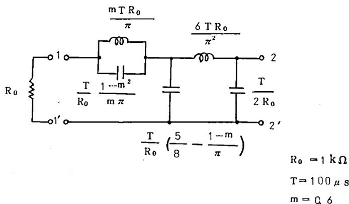
図 5.16 実験に用いた濾波器の構成
