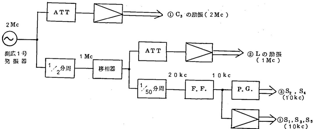
図 4.15 実験回路のブロック図
