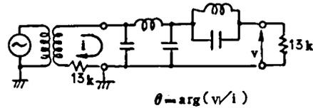
図 3.17 実験に用いた尹波器の  $\theta$  特性
