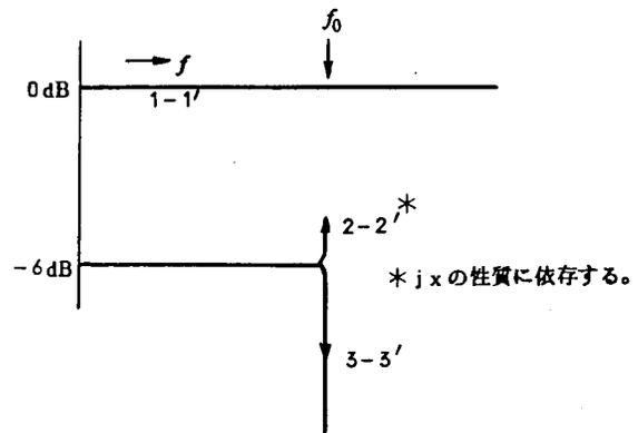
図 3.2 の実験回路は、濾波器、レゾナント・トランスファ回路とも理想な場合は、本来図 3.4 のような特性を示すと考えられる(節 5.1.4 参照)。
