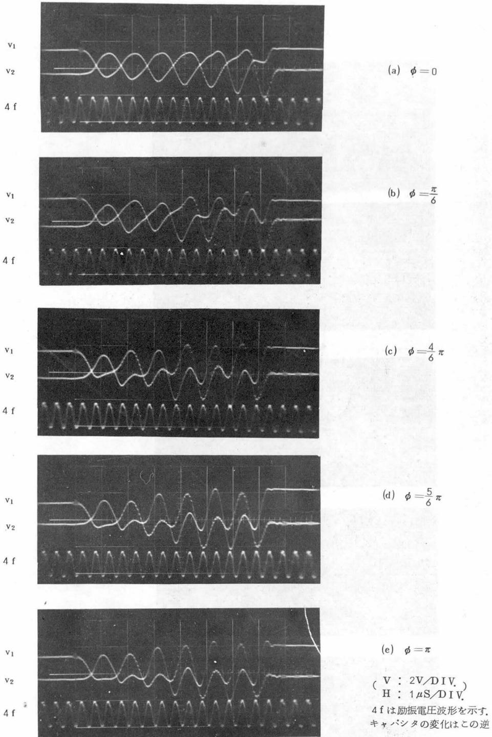
図 4.17 キャパシタのパラメータ励振の位相  $\phi$  を変化させたときの共振波形の変化
