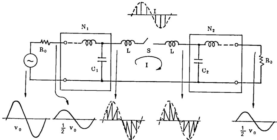
図 1.6 2 線式時分割通話路の各部波形の概略
