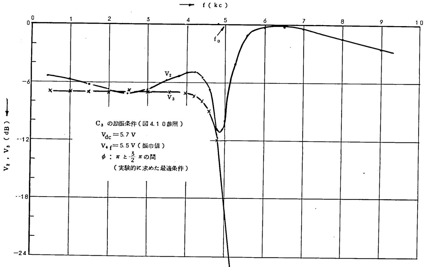
図 4.2.1  $V_2, V_3$  のレベル特性 (Ⅻ,  $C_3$  を励振した場合)
