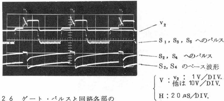
図 2.26 ゲート・パルスと回路各部の波形
