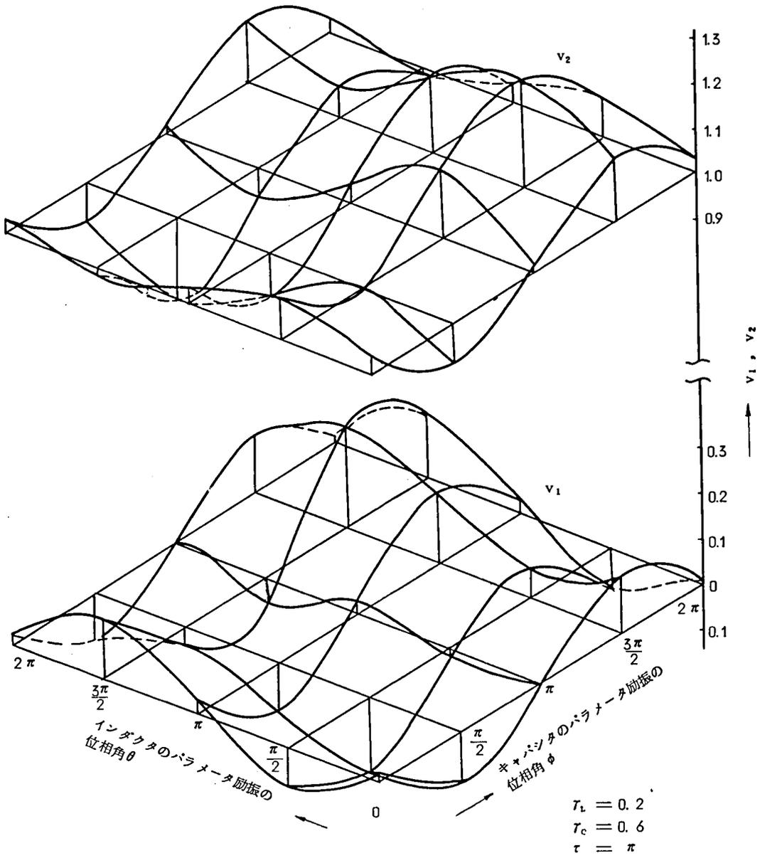
図 4.6  $\tau = \pi$  における  $v_1, v_2$  の、パラメータ励振の位相  $\theta, \phi$  による変化例
