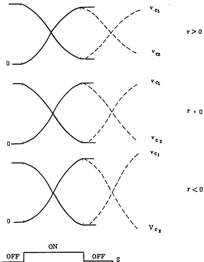
図 2.2 レゾナント・トランスファ回路中の抵抗成分と共振現象の関係
