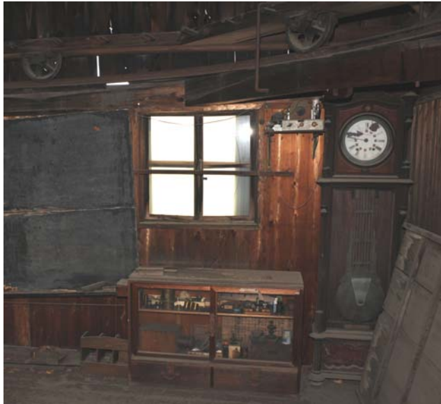
第2観測室南西隅に設置された Brandt 製重錘式大時計 足元に望遠鏡の部品が納められたガラス戸戸棚があった。
