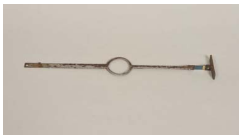
振り子の支点部。右が上で青い部分が補修済みの薄い青銅板である。左が下で振り子を吊り下げる。
