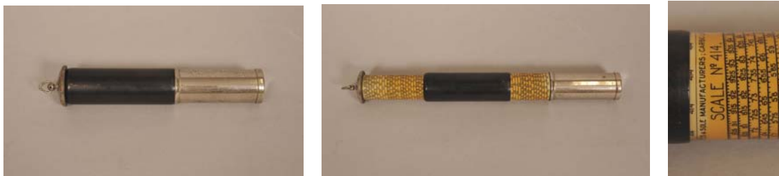
4 桁円筒計算尺 (ロンドン Carbic 社製)
