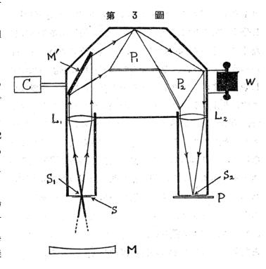
イド動作で太陽像全体を走査すると CaIIK 線単色で観測した太陽全面像が乾板 P に焼きこまれることになる。なお、スライド動作は、錘 W の重力落下が動力であり、オイル調速器 C で一定速度になるような機構となっている。
