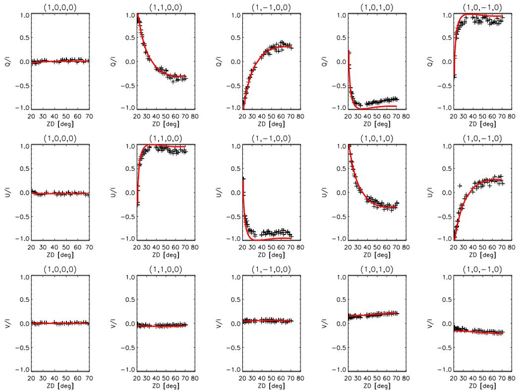
キャリブレーション用の観測データ (黒十字) と望遠鏡偏光特性モデルによるフィッティング (赤線)。観測データはストークスベクトル  $(I, Q, U, V) = (1, 0, 0, 0), (1, \pm 1, 0, 0), (1, 0, \pm 1, 0)$  の偏光をそれぞれ望遠鏡に入射し、He I 近傍の連続光の偏光度を測定したもの。横軸は観測時の太陽の天球上の位置を示す角度の 1 つ Zenith distance。
