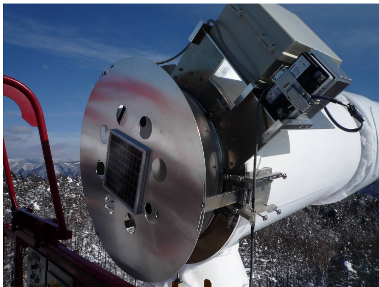
写真: DST 望遠鏡入射口に設置された偏光フィルター自動回転装置
