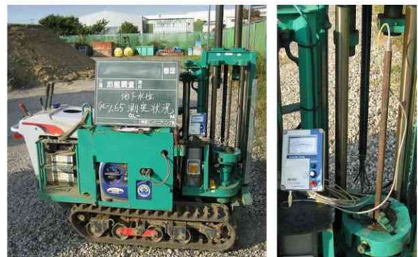
写真-1 SWS試験孔を利用した地下水位測定状況
