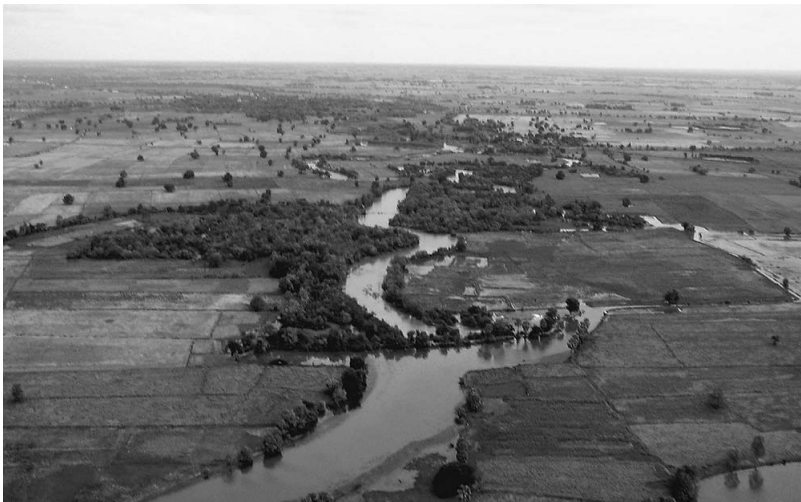
写真1 東北タイ西南部ナコンラーチャシーマー県にある Thamnop Khon Muang 注：上流側上空からの撮影。川を横切る土堰堤によって流れが完全にせき止められている。(撮影：福井捷朗)
