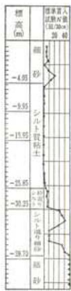
建設地点は、東京湾に面した千葉の臨海埋立地である。地盤構成のあらましは、左図に示すように、旧海底地盤面 (AP - 5m) 以下 AP - 30m までが軟弱な沖積砂質シルト層、AP - 40m 以深に海成洪積層砂の支持層が存在する。表層は軟弱なために建設用の重機械が入れる状態ではなく、サンドマットを敷設した後、サンドドレーン、サンドコンパクションパイル各工法を2段階に分けて打設し、地盤改良を行った。
