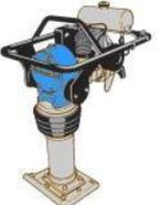
ハンドガイド式の締固め機で、上部に搭載したエンジンの回転力をクランク機構によって往復(上下)運動に変換して、器械下部の打撃板に伝達する。間にスプリングを咬まし、上下運動を増幅させる。
