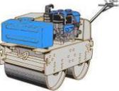
ハンドガイド式の小型振動ローラー、自重600~800kg級が一般的で、2軸の鉄輪で、全輪振動・全輪駆動式が多い。
