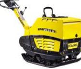
振動による締固めと前後進が容易な締固め機械
