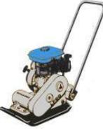
ハンドガイドによるプレート式の振動締固め機。これは起振機を平板の上に搭載し、偏心軸を高速回転させて遠心力を発生させて、その振動により締固めと自走を同時に行うものである。
