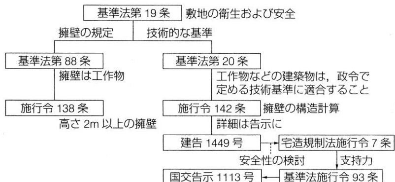
図-2 擁壁に関する建築基準法の規定の概要 2)
