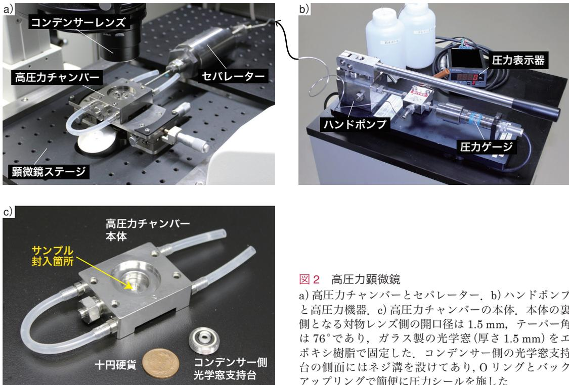
図2 高圧力顕微鏡
